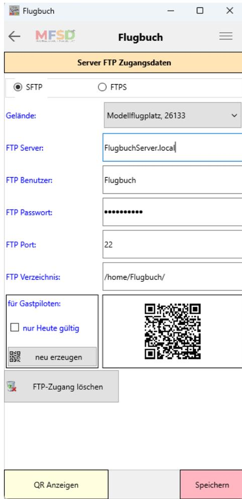
11. Nun können die Flugbucheinträge mit dem Flugbuch-Server im lokalen Netzwerk synchronisiert werden. Um ein eigenes Netzwerk auf dem Fluggelände nutzen zu können muss der Raspberry Pi Zero als Accesspoint eingerichtet werden. Darum kümmern wird uns im 2. Teil dieser Anleitung (Autor Frank Tofahrn). Nun folgt aber zuerst eine Funktionskontrolle.
